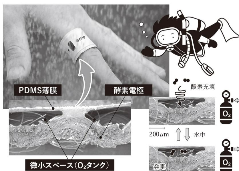
ウォータープルーフ仕様のBIPP®が実現し、水仕事や入浴の最中にもユースケースが拡がりました。カソード電極にO<sub>2</sub>透過性の防水フィルムを一体化し、接合部にO<sub>2</sub>タンクとして働く微小スペースを形成。水中でも発電を維持し、タンクのO<sub>2</sub>が尽きても、水から取り出せば数10秒で再充填されて発電性能が回復します。さらに、口腔内や体内で利用するバイオ発電デバイスの開発にもつながる機能です。
